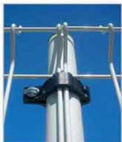
Tubolare in lamiera d'acciaio zincata a sezione tonda (diam. 40 sp. 1,5 mm), completa di attacco a collare per il montaggio della rete sulla piantana.
