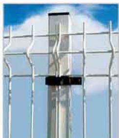
Tubolare in lamiera d'acciaio zincata a sezione quadrata (50 x 50 x sp. 1,5 mm), completa di attacco a collare per il montaggio della rete sulla piantana.
