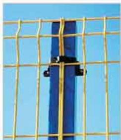
Tubolare in lamiera d'acciaio zincata a sezione quadrata (60 x 60 x sp. 1,5 mm), completa di attacco a collare per il montaggio della rete sulla piantana.
