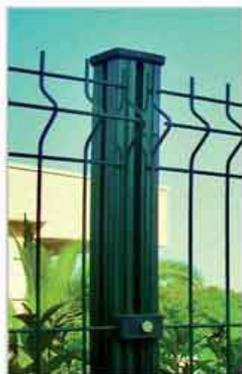
Piantana in lamiera d'acciaio zincata a sezione quadrata (60 x 60 x 1,2 mm) con tre scanalature per consentire l'innesto degli accessori per il fissaggio dei pannelli.
